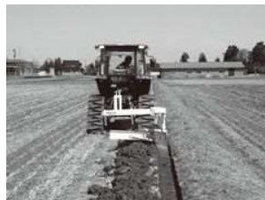
写真①：溝切機による排水溝 写真②：排水口への連結
